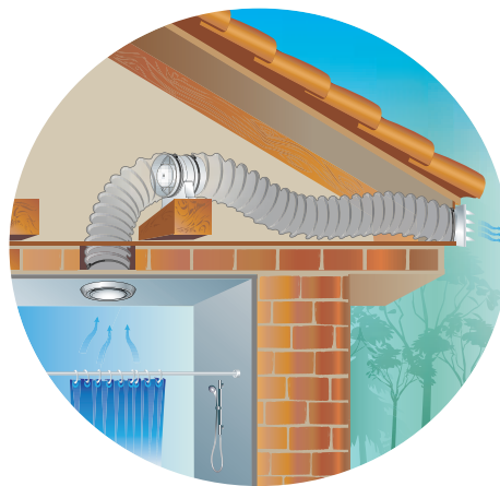
VKOK fan cottage ventilation example
